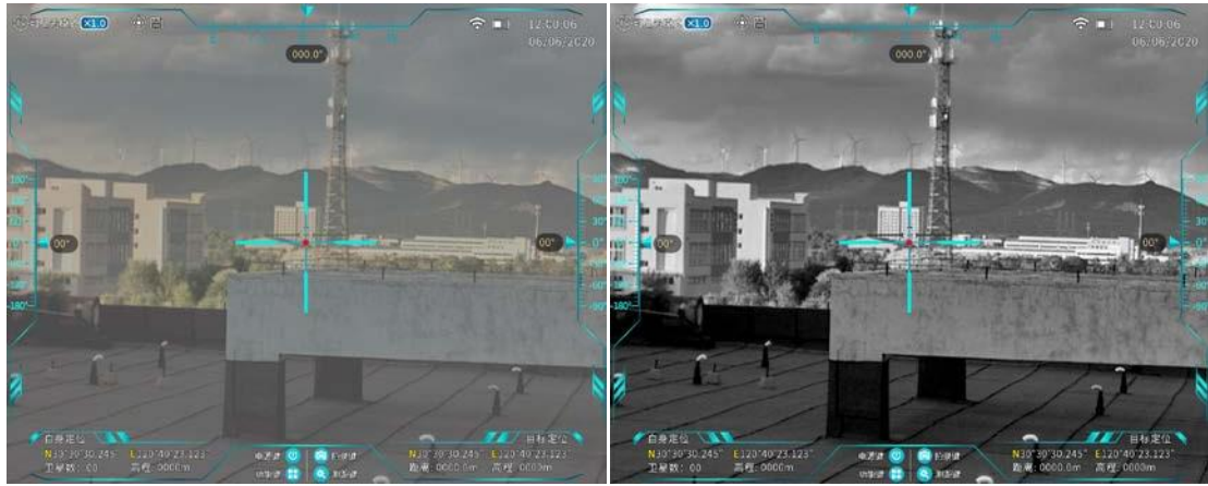
图 29 可见光透雾效果（左：透雾关闭，右：透雾打开）
