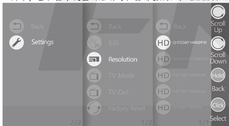
**TV Out (连接到电视上显示):** 先把产品附带的 AV 视频线插入产品视频输出口“19”, 另连一头连接到 TV 上的 CVBS 接口上置设好 TV 的对应信号输入模式, 然后 长按“9”2秒进入主菜单→TV Out→On, 进入 TV Out 模式后此时产品图像会转到 TV 上显示, 机器显示屏立即会变成黑屏。
